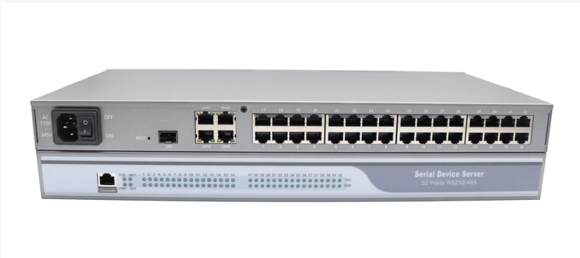
赛诺联克 (SERIALLINK) SLK-S532R-PLUS 串口通信服务器是将 32 路分散、低速、不同标准的 RS232/485 串口设备转换成以太网进行集中管理的设备。内建双核 880MHZ 工业级 CPU, 2Gb RAM, 4 个 1000M 以太网口, 1 个 SFP 光口, 每路串口波特率最高可支持 921600bps.通常上位机使用 TCP 客户端连接串口服务器, 对串口设备进行透明双向通信。SLK-S532R-PLUS 串口通信服务器支持多种工作模式, 如 TCP Server 模式、TCP Client 模式、UDP Server 模式、UDP Client 模式、MODBUS RTU 转 MODBUS TCP Server 模式。同时也支持安装驱动, 虚拟成 32 路 COM 口。该产品已经广泛应用于机房监控、交换机路由器生产测试、电信网络设备远程管理、能源调度、化工信息化工厂、楼宇自动化等应用环境。
